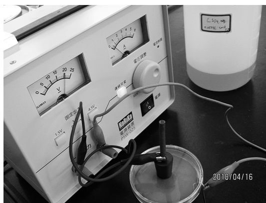
図2 磁気電気分解実験に用いた器具。
