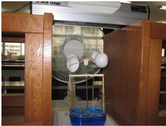
Photo 2 UV照射下において扇風機の風を風車にあてて攪拌翼でメチレンブルー水溶液(酸化チタン(IV)ナノ粒子を含む)を攪拌して光触媒反応を行っている様子。
