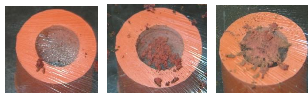
図5 左から、硫酸銅(II)水溶液の濃度が0.050 mol/L, 0.10 mol/L, 0.15 mol/Lの銅片 (印加電圧は20 V)
