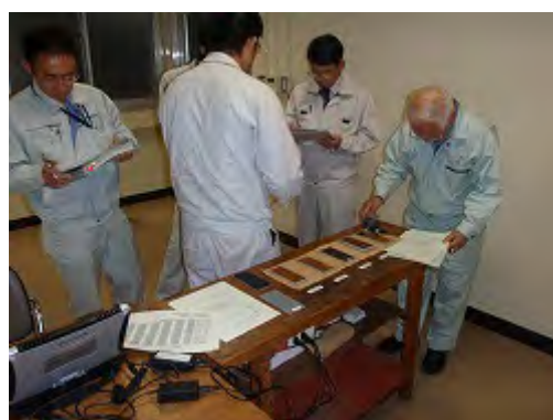
写真 4 錆厚測定状況
