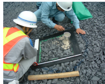
写真-4 サンドパッチの敷き砂状況
