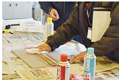
浸透探傷試験
