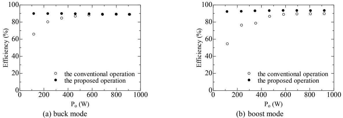
Figure 16. Power efficiency: (a) buck mode ( $V_{\text{in}}=200\text{V}$ ,  $V_{\text{out}}=150\text{V}$ ); (b) boost mode ( $V_{\text{in}}=100\text{V}$ ,  $V_{\text{out}}=150\text{V}$ ).
