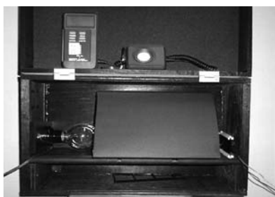
図5 特性測定用暗箱（横44cm×縦30cm×奥行22cm） （上方；照度計，下方；左側から裸電球（40W型）， 集光器（三角柱状鏡筒），測定用太陽電池）
