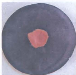
写真 1 青色リトマス試験紙に酸性の水溶液を垂らした際の色の変化
