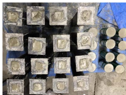
写真 2.1.c 打設後試験体一覧
