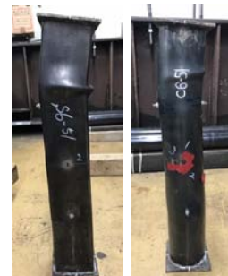
写真 3.b 実験後の 600mm 試験体
