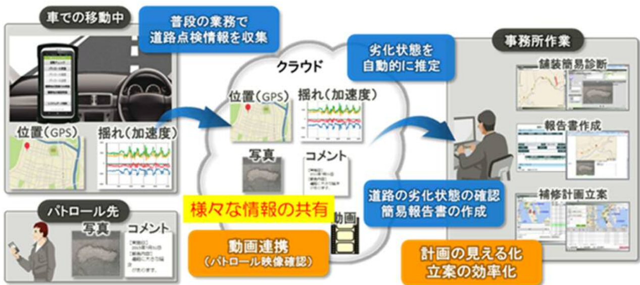
Fig. 1 道路パトロール支援システム (道パト) による道路点検システムの概要図
