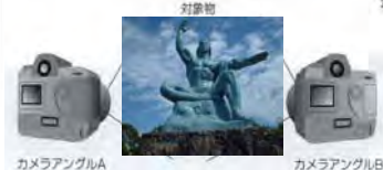
デジタルカメラを用いた3Dデジタル写真計測(ステレオ法)
