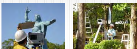
3Dレーザスキャナーによる計測(光レーザ法)
