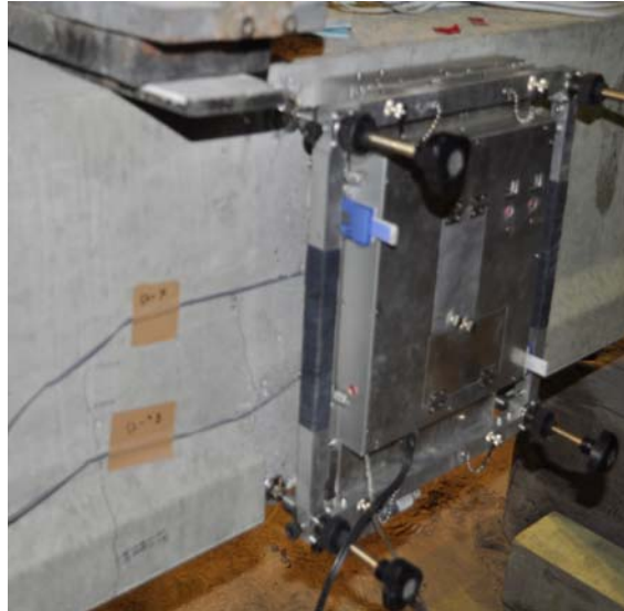
写真－4.2.3 スキャナ装置設置状況
