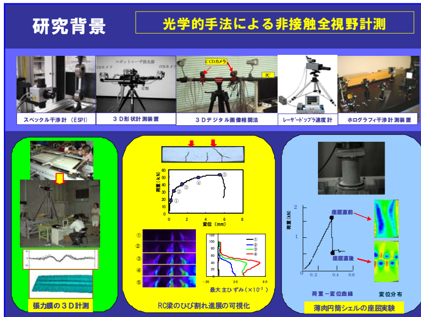
図－1.4.1 種々の光学的計測法
