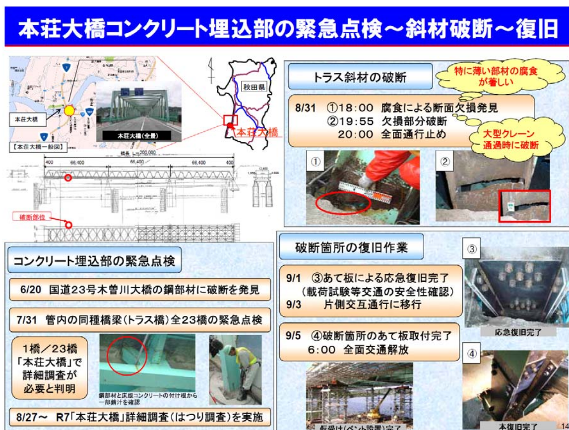
図－1.3.4 本荘大橋のトラス斜材の破断 [14]
