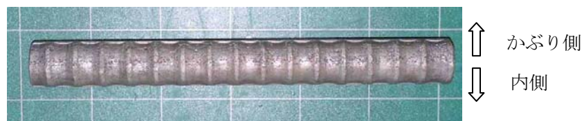
写真-8.3.3 電食後の鉄筋
