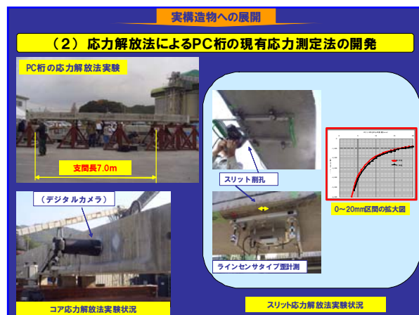
図一1.4.4 応力解放法への適用
