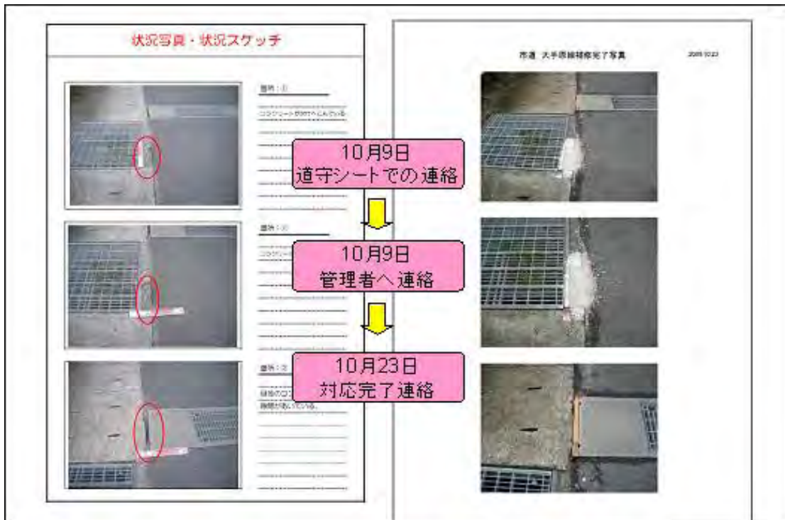
図-1 道守シート活用事例
