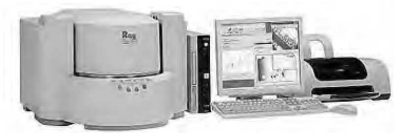
写真-3.5.1 蛍光 X 線分析装置 SHIMAZU 社製 RAYNY EDX
