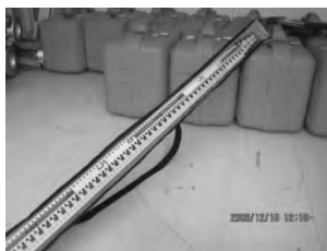
標尺 (橋の高さを測る)
