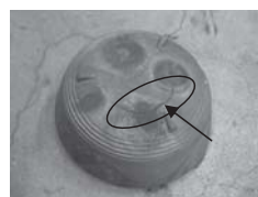
(c) 鑄鉄製鍋の鍋底の亀裂例 (印部矢印)
