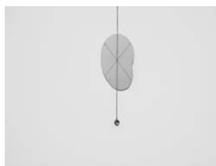
図3 原板の重心の求め方
