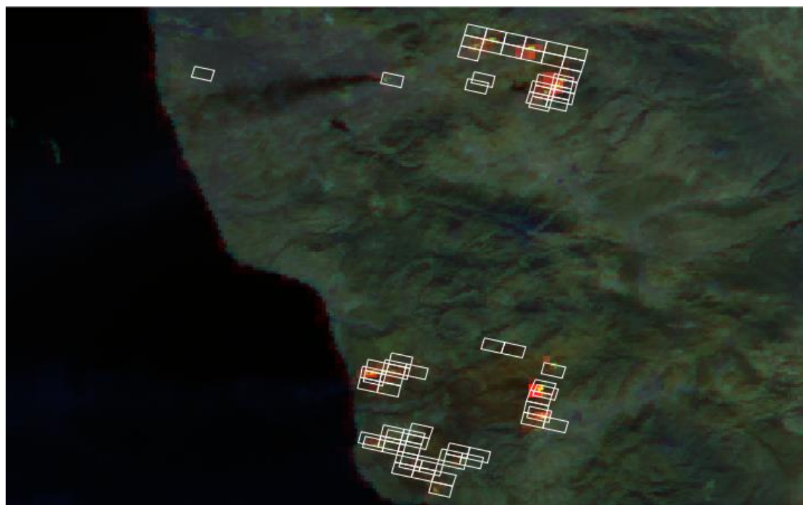
図 28 本研究にて使用した SGLI と同期観測した MODIS 火災プロダクトの一例。米国カリフォルニア州サンディエゴ近郊において 2019 年 10 月 25 日に観測された林野火災である。下絵は SGLI フォールスカラーコンポジット画像(R:G:B = SW4:SW3:VN11)。このコンポジットでは、火災画素は赤～黄に見える。白いグリッドは SGLI と同期観測した MODIS 火災画素。
