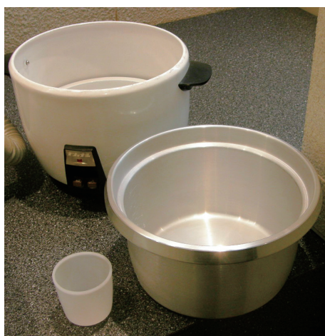
図15. 二重釜での水の管理を不要とした （センタータッチ方式）直炊き電気炊飯器 （松下電器歴史館蔵）
