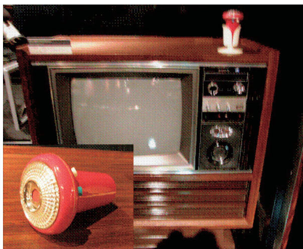
図22. 「ズバコン」1971発売の超音波リモコン (サンヨーミュージアム蔵)
