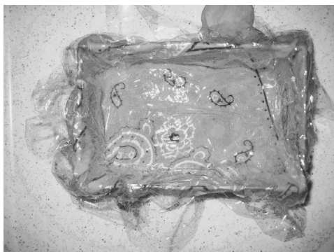
写真4 型枠上に布とサランラップを敷いた
