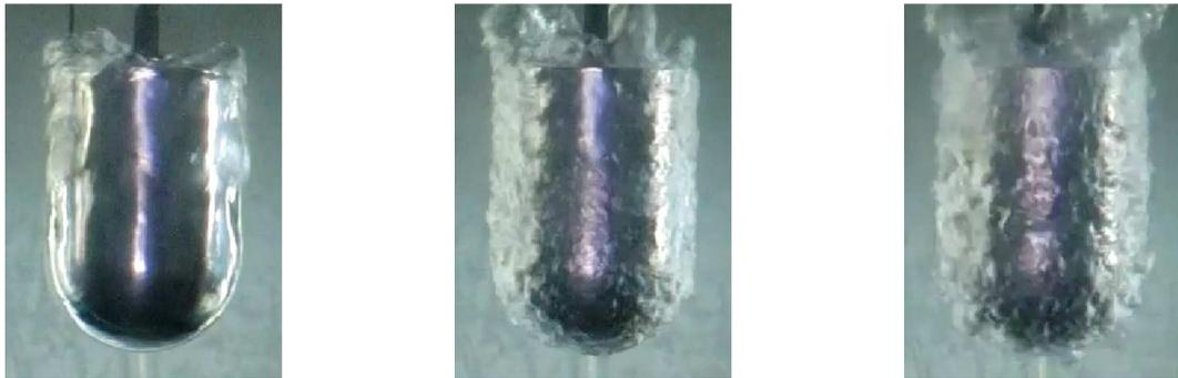
(d)  $\tau=85\text{sec}$ ,  $T_c=258\text{ }^\circ\text{C}$ ,  $T_s=257\text{ }^\circ\text{C}$  (e)  $\tau=90\text{sec}$ ,  $T_c=247\text{ }^\circ\text{C}$ ,  $T_s=245\text{ }^\circ\text{C}$  (f)  $\tau=95\text{sec}$ ,  $T_c=231\text{ }^\circ\text{C}$ ,  $T_s=228\text{ }^\circ\text{C}$
