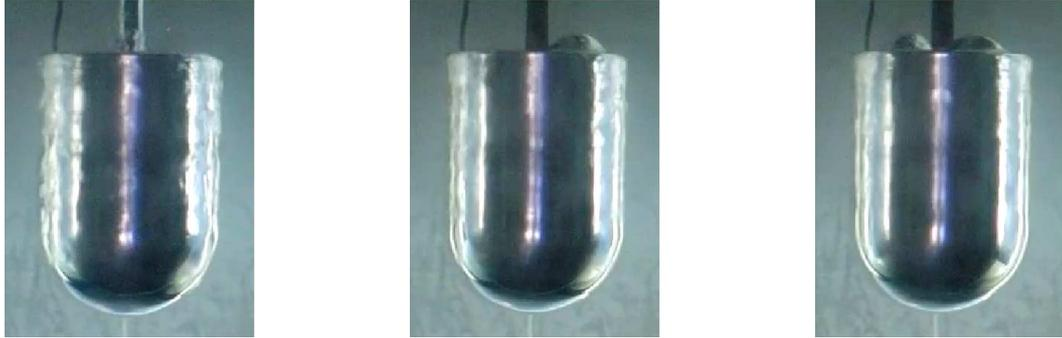
(a)  $\tau=0\text{sec}$ ,  $T_c=560\text{ }^\circ\text{C}$ ,  $T_s=554\text{ }^\circ\text{C}$  (b)  $\tau=9\text{sec}$ ,  $T_c=488\text{ }^\circ\text{C}$ ,  $T_s=482\text{ }^\circ\text{C}$  (c)  $\tau=12\text{sec}$ ,  $T_c=464\text{ }^\circ\text{C}$ ,  $T_s=458\text{ }^\circ\text{C}$
