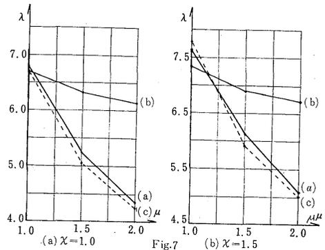
ことがわかるが, ⑥の場合, すなわち x 方向に反力モーメントを生ずるとき固有値は, ④, ⑤の場合に比較して  $\mu$  の変化による影響が少ないといえる. このことは  $\mu$  が増大するにつれて, 板全体の剛性が減少することおよび x 方向に比べて y 方向の剛性が低くなることに起因するものである.
