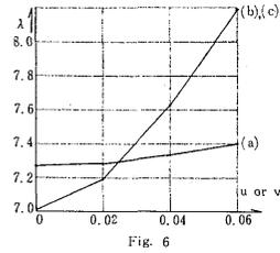
なお、 $u=v=0$  の場合の固有値は式(29-1), (29-2) および式(30)より求めたものである。① および ③の場合は、 $\lambda$  の算定に柱の反力モーメントしたがって柱の曲げ剛性の影響が含まれることになるゆえ、 $\lambda$  は  $u, v$  の増加に伴って著しく増大する。②の場合は、柱の垂直反力の項のみで  $\lambda$  が決定され、したがって、 $\lambda$  に対する  $u, v$  の影響は小さい。さらに、④の場合は柱に何等の反力をも生ぜず、 $\lambda$  は余関数の項から決定されるゆえ、 $u, v$  の変化に対して全く無関係である。このことは、本題の解析にあたり、柱断面の中央1点のみで中間柱と板の変形条件をたてたことに起因するもので、柱の剛域を考慮する物合には異なる結果をうることになるであろう。
