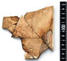
16-3 2号墓床面の薄緑無地6インチ平タイル裏面 菱形「DK」刻印 井桁影り0.5mm
