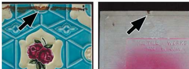
図5 月星建陶社製のチューブライニングタイル。表面には家具に取り付けられた際のニスが付着し、裏面には釘止めされた欠けが認められる。
