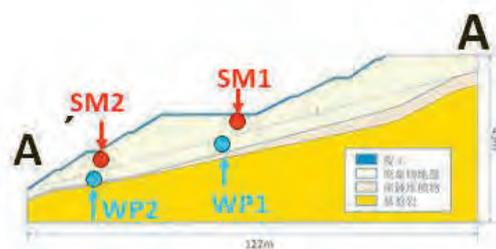
図 7.1.4 対象斜面の断面図
