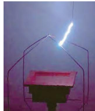
写真 7.1.5 避雷ケージに橋絡する模擬雷
