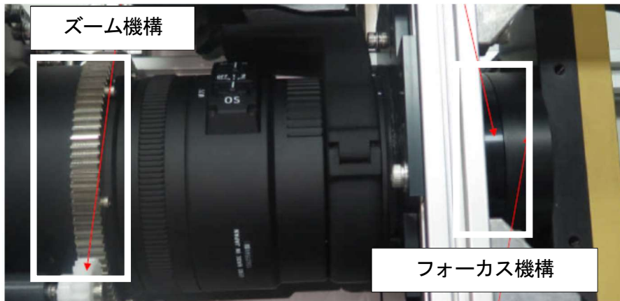
図 4.2-3 ズーム，フォーカス制御機構
