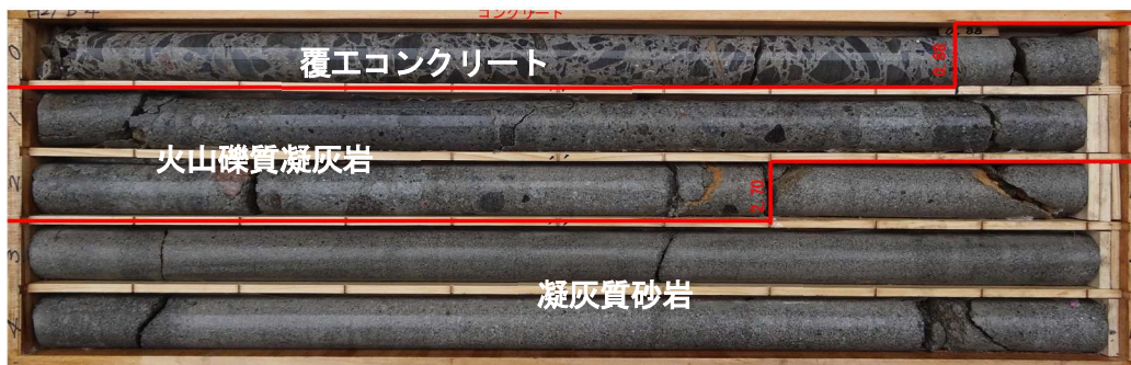
写真 7.4-3 調査ボーリングコア写真（水平，下り，No.58）
