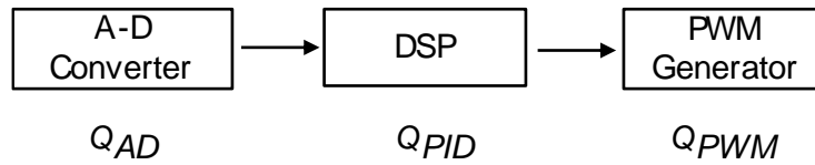
図 4.2 デジタル PID 制御の回路構成
