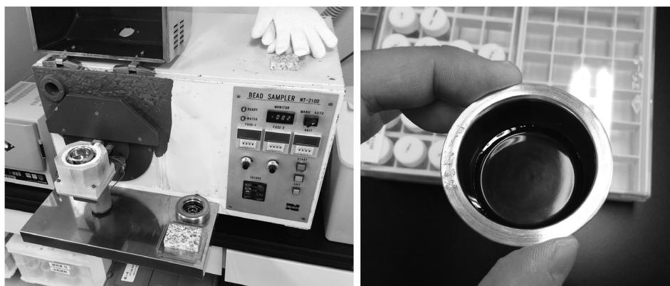
図1 長崎大学教育学部に設置の高周波溶融装置(NT-2100, 左)とガラスピード(右)
