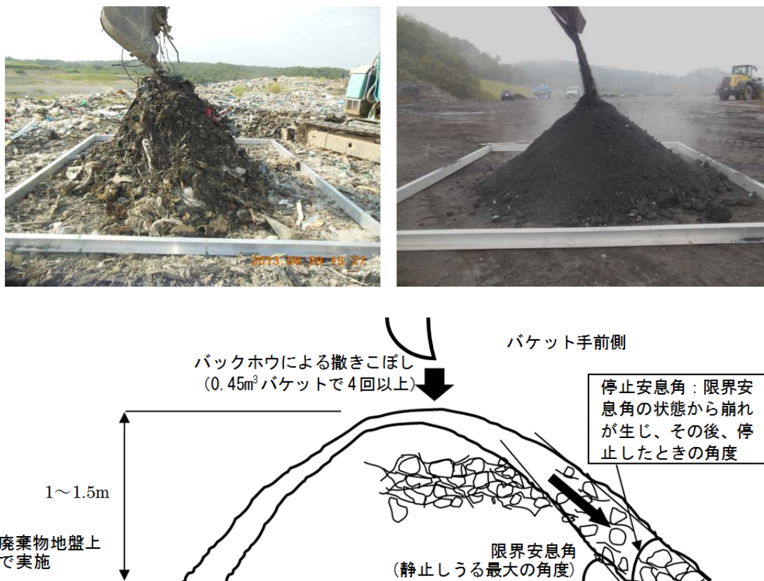
図2-7 安息角試験 上左：中部A1，上右：東北B（燃え殻） 下：安息角試験のイメージ
