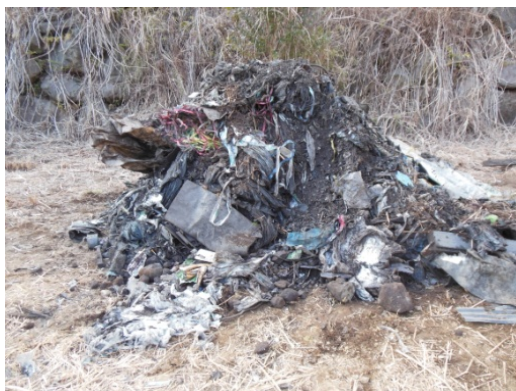
図 3-45 左側 60^\circ 、右側 40^\circ の試験用の山
