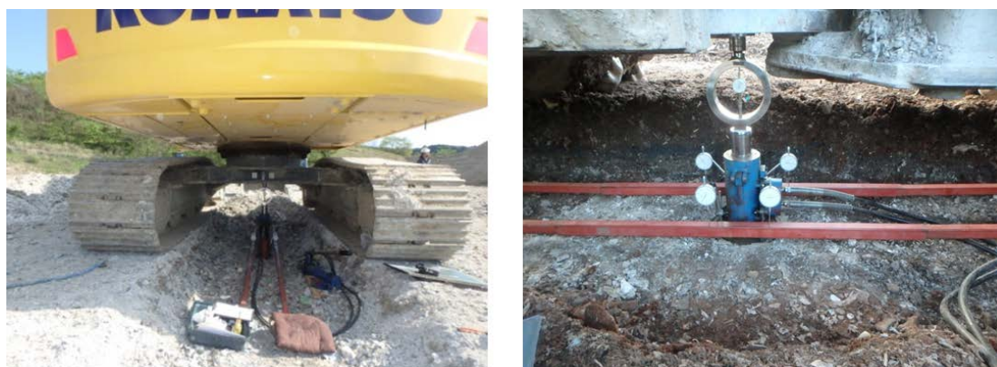
図 2-5 平板載荷試験（左：中部 A1 現場，右：関東 B1 現場）
