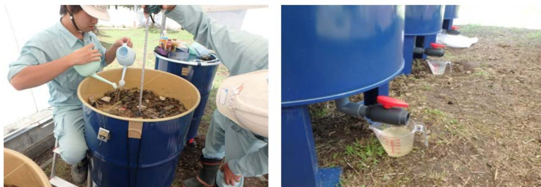
図 5-2 大型カラム実験 (左: 注水状況 右: 排水状況)
