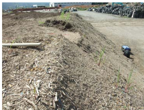
図 3-41 法肩部へのバケットによる载荷(東北 E) 図 3-42 载荷後(200mm 沈下, 20mm はらみだし)
