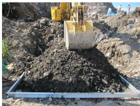
図 3-44 鉛直上方からの载荷実験後 (中部 C1・プラスチック等少)
