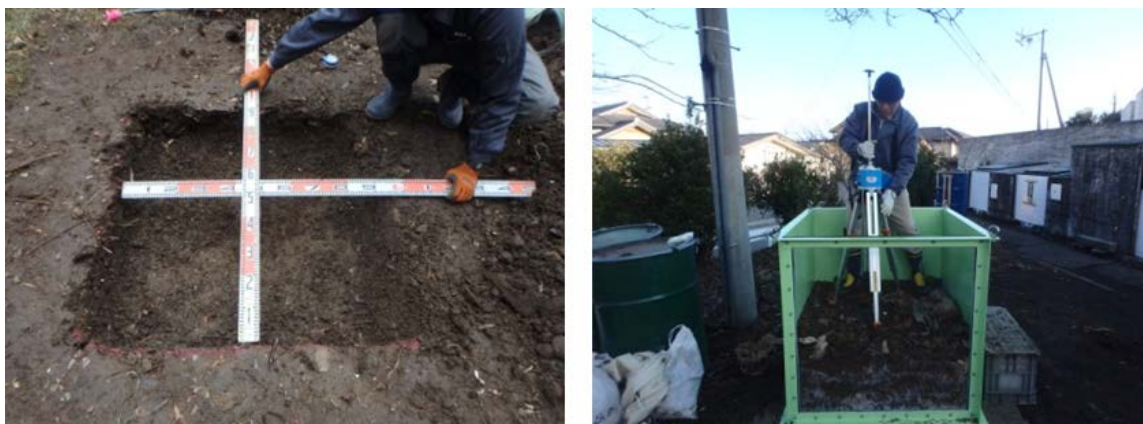
図 2-15 衝撃加速度試験（キヤスポル）の影響範囲確認実験
