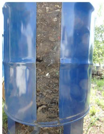
図 5-9 注水 6 か月後の実験容器内 (中部試料, 残水量 13mm, 少量の排水あり)
