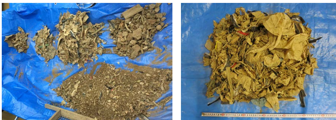
図 2-1 20mm 篩いで篩い分けされた廃棄物（左）と，10cm 以上の軟質プラスチック（右）
