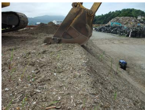
図 3-41 法肩部へのバケットによる载荷(東北 E) 図 3-42 载荷後(200mm 沈下, 20mm はらみだし)
