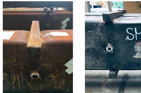
Photo1 実験後のフランジ部(左：長方形, 右：正方形)
