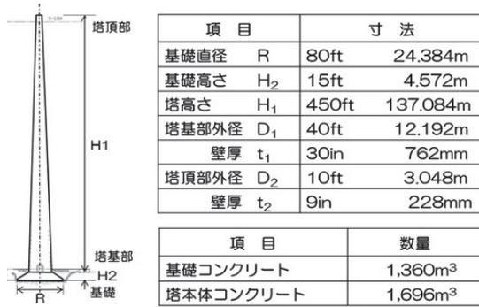
図-2 1号塔の詳細寸法およびコンクリート数量
