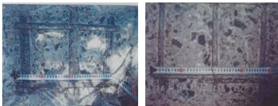
写真 7.2-1 塔基部の発錆がみられない鉄筋
