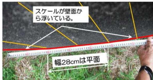
写真 5.1-3 外型枠曲面の形状
