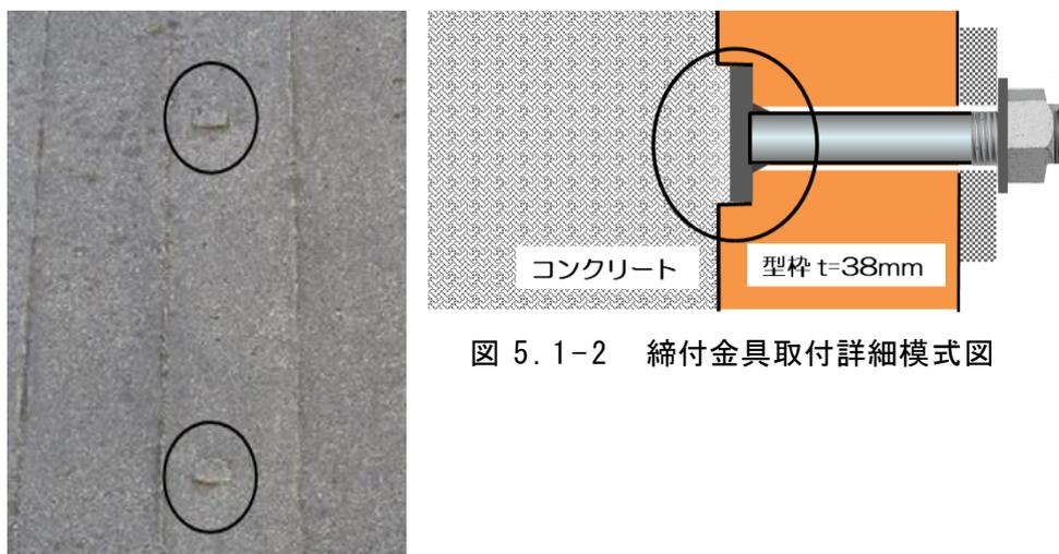
図 5.1-2 締付金具取付詳細模式図
