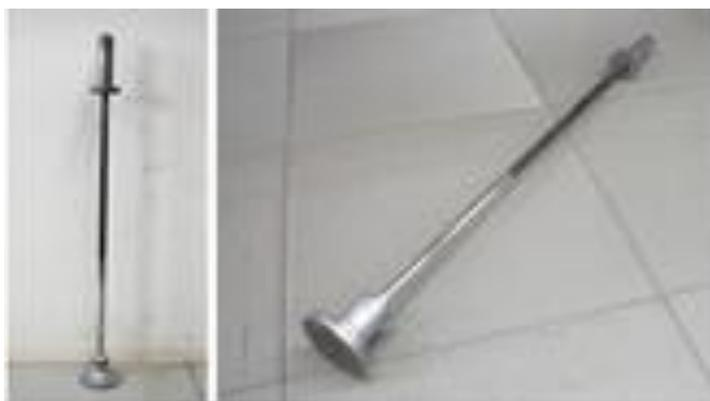
写真 8.1-1 試作した金属製の搦固蝟(先端直径 10cm)
