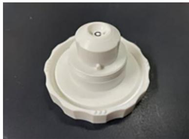
**Figure 1.** The artificial anterior chamber.
