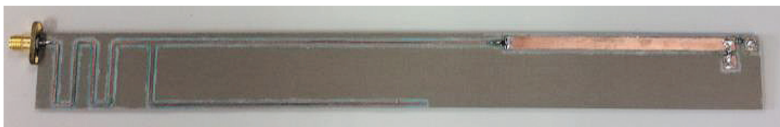
図 2-2 レクテナ（整流回路＋整合回路）の試作品
