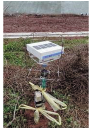
写真 3-1 避雷ケージ付きセンサ端末
