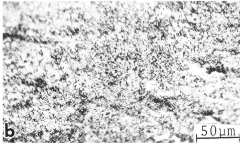
第12図 HgTe 結晶の極性面の腐食模様。 (a) : \{111\}_A 面上に現れた三角形ピット, (b) : \{\bar{1}\bar{1}\bar{1}\}_B 面の腐食模様。
