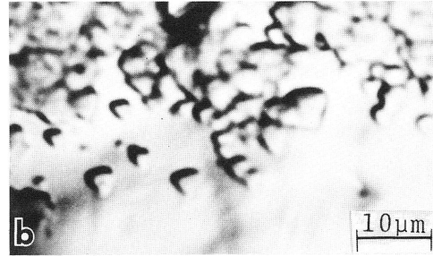
第13図 HgSe 結晶の極性面の腐食模様。 (a) : \{111\}_A 面の腐食模様, (b) : \{\bar{1}\bar{1}\bar{1}\}_B 面上に現れた三角形ピット。
