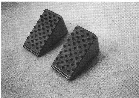
図1 足踏み器A（表面に突起物を有し、踏み圧10kgのスプリング内蔵）
