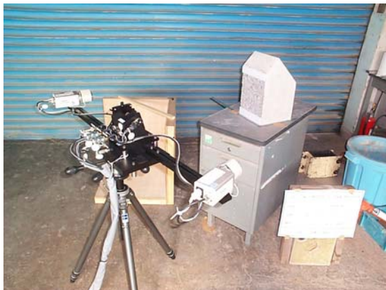
図-2.6.6 コンクリート表面計測状況
