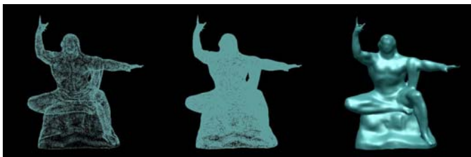
(a) 点群 (b) ワイヤフレイ (c) サーフェイス 図－4.3.10 三次元幾何モデル(三次元写真)計測
