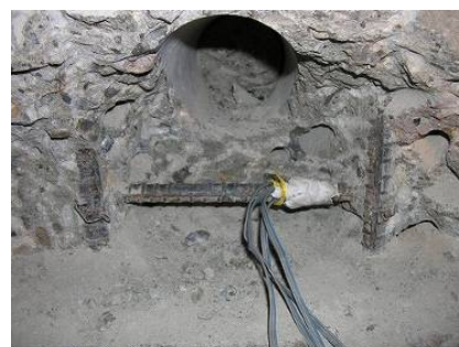
写真-4.6.2 鉄筋切断法
