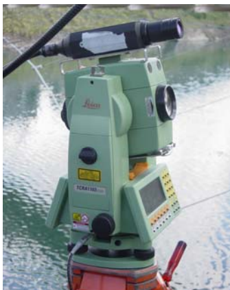
図－4.7.6 T Sに搭載したL D V
