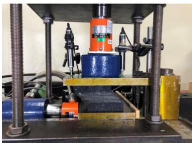
Fig. 15 圧縮せん断試験機
