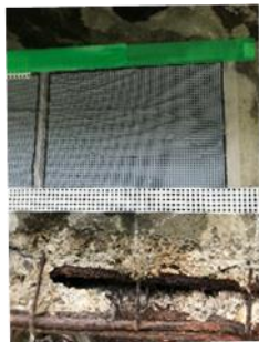
Fig.17 格子ターゲット Fig.18 SMCによる計測風景
