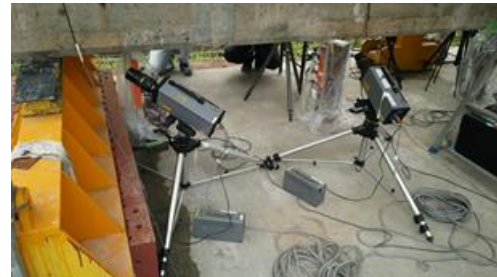
Fig.5 LDVによる振動計測の様子
