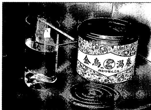
図17 凸型をした洗剤用透明容器による 光の道筋観察装置
