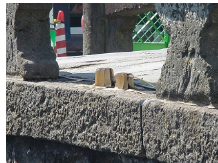
Photo. 5 加速度計設置図写真
