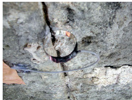
Photo. 6 クリップ型変位計設置図
