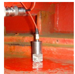
Fig. 6 加速度計設置状況
