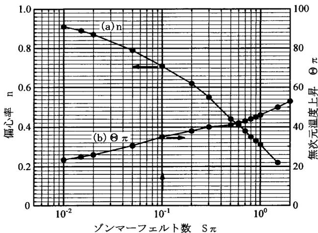
図5 偏心率  $n$ (a), 無次元温度上昇率  $\Theta \pi$ (b)とゾンマーフェルト数  $S \pi$  の関係
