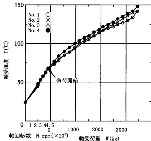
図8 軸受温度計測結果
