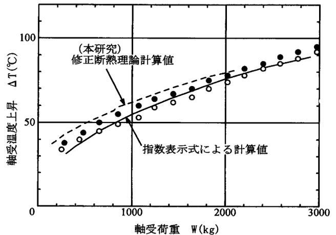
図9 軸受温度上昇の計算, 実験結果の比較
