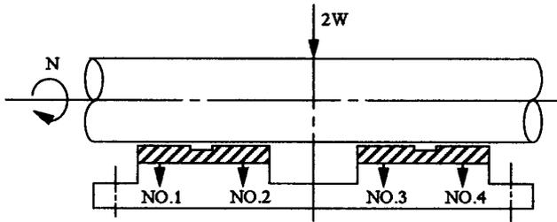
図7 試験部分と軸受温度計測点
