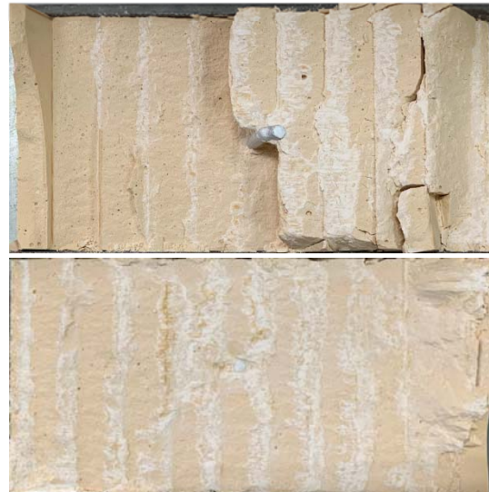
(d) i=60^\circ Block failure (Energy-absorbing bolt)
