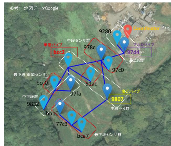
図-1 Web 経由で現地の遠隔モニタリングを行っている様子（PC のキャプチャ画面）
