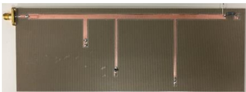
写真-2 レクテナ（整合回路+整流回路）試作品
