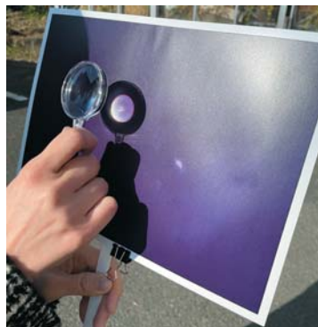
図3 示温シールを用いて虫眼鏡で集めた光の暖かさを調べる実験の様子
