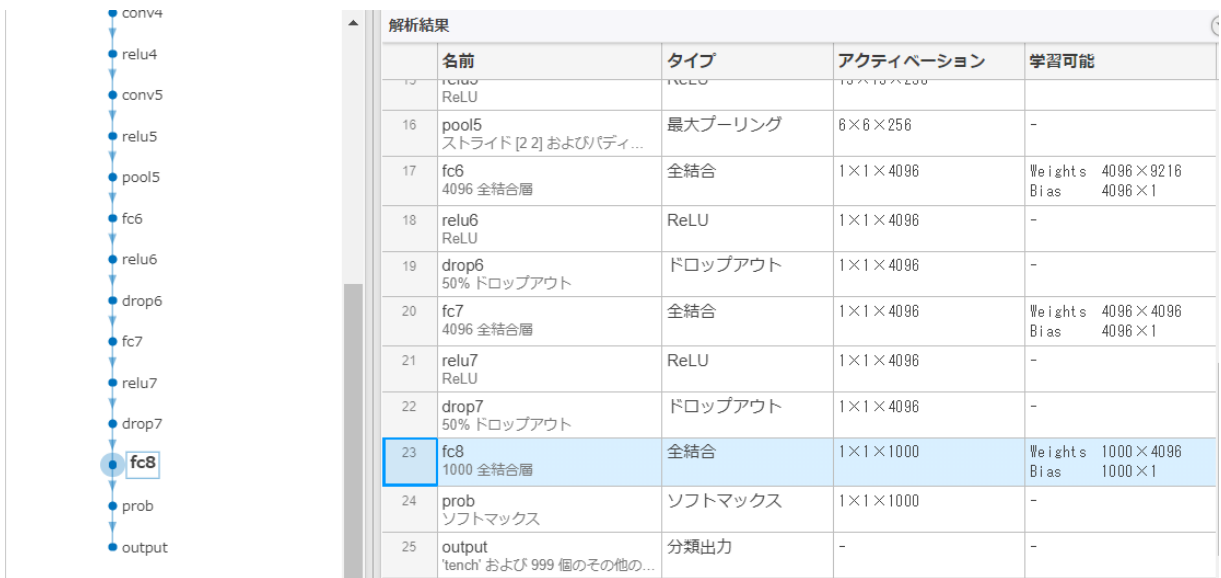
図 4-4 AlexNetの出力部分の構成 (MATLAB Deep Learning Network Analyzer)
