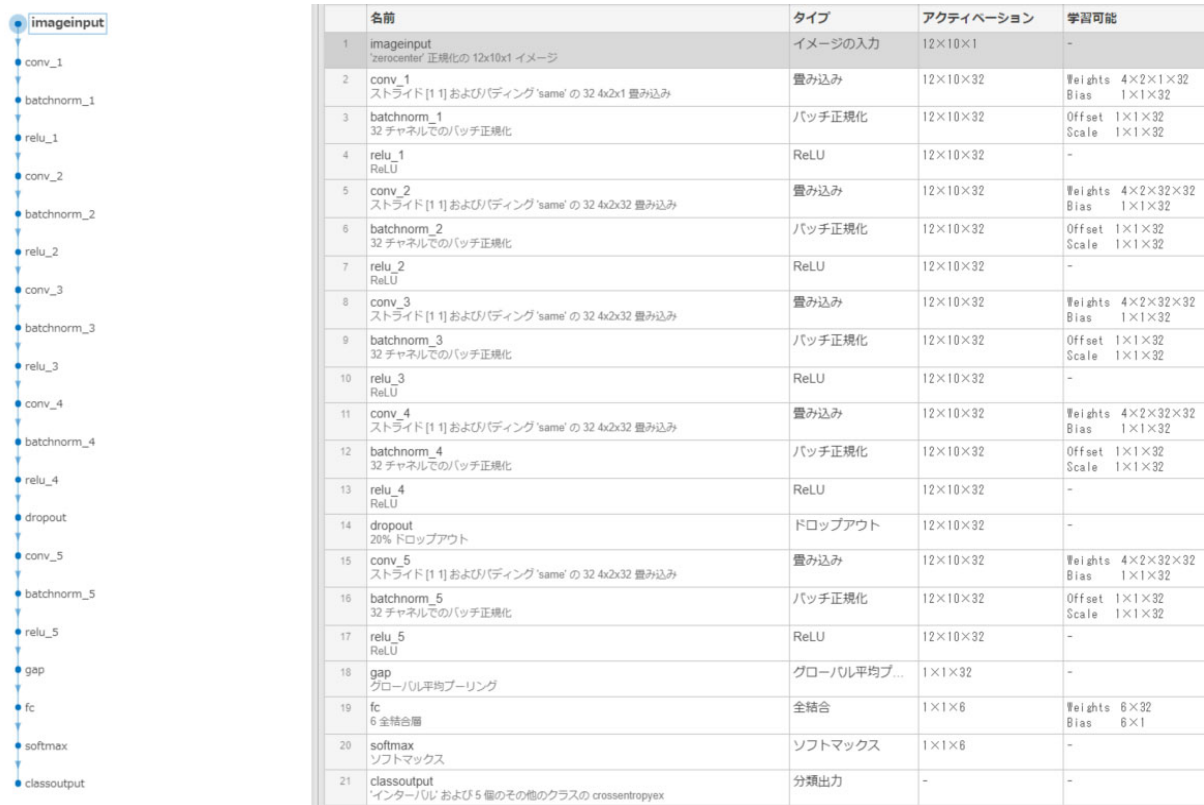
図 5-8 作業動作分類用のネットワークの構造 (MATLAB Deep Learning Network Analyzer)
