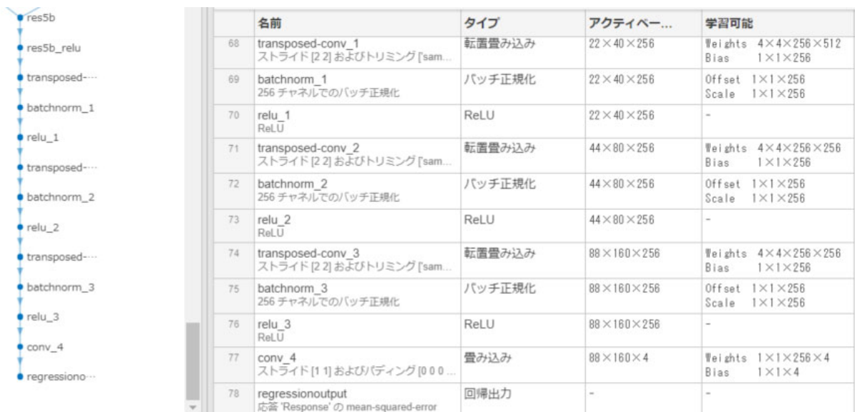
図 5-5 転移学習用に調整したResNet-18の出力部分 (MATLAB Deep Learning Network Analyzer)
