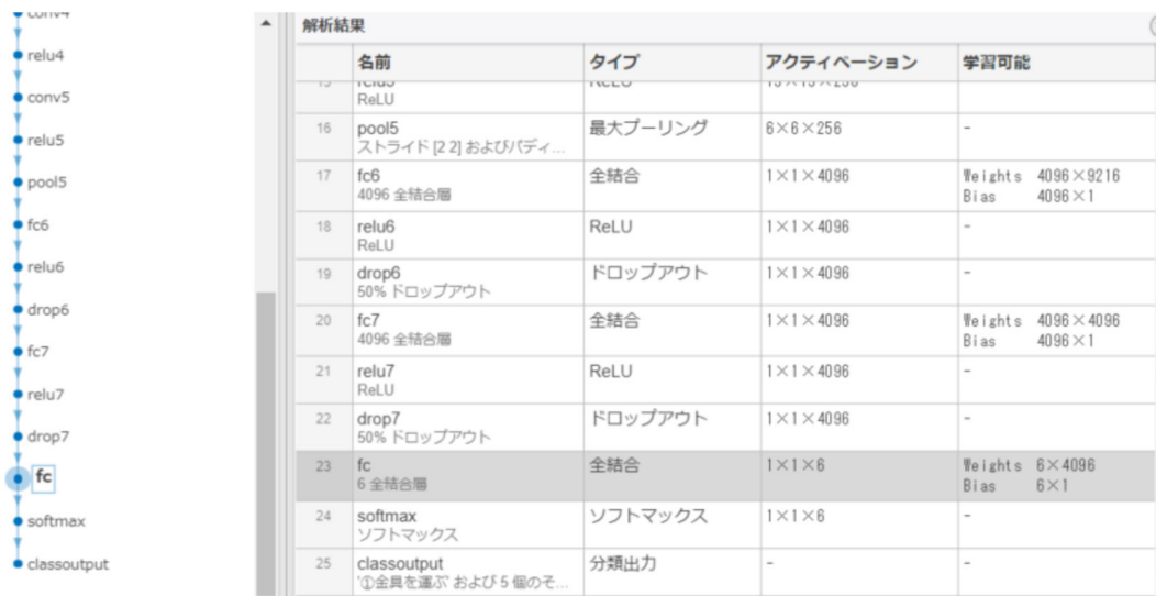
図 4-7 転移学習用に調整したAlexNetの出力部分 (MATLAB Deep Learning Network Analyzer)
