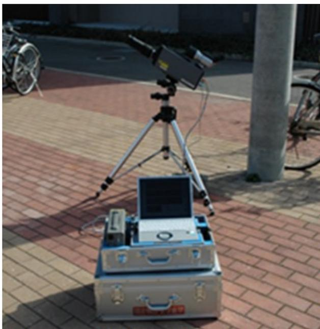
図 5.27 レーザードップラー速度計 (LDV)
