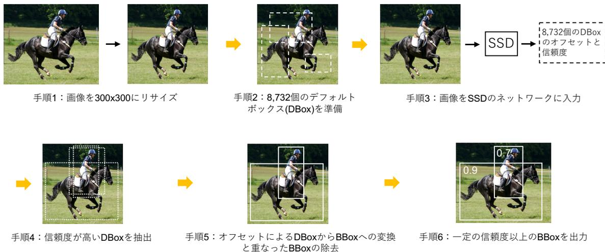
図 4.5 SSD の処理の流れ
