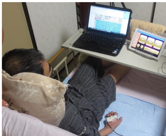
Fig. 2.15 Implemented environmental control system for an ALS patient
